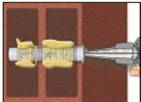
6. Die Siebhülse vom Grund her mit Mörtel füllen. Die exakte Mörtelmenge ist dem Kartuschenetikett oder der Montageanleitung zu entnehmen. Die temperaturrelevanten Verarbeitungszeiten (Tabelle B4) sind zu beachten.
