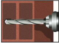
3. Das Bohrloch, senkrecht zur Oberfläche des Verankerungsgrundes, mit Bohrverfahren nach Anhang C4-C34 mit vorgeschriebenem Bohrerennendurchmesser und Bohrlochtiefe entsprechend der Ankergröße und Einbindetiefe des gewählten Dübels im Verankerungsgrund erstellen. Bei Fehlbohrungen ist das Bohrloch zu vermörteln.
