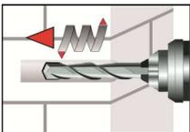
3. Das Bohrloch, senkrecht zur Oberfläche des Verankerungsgrundes, mit Bohrverfahren nach Anhang C4-C34 mit vorgeschriebenem Bohrerennendurchmesser und Bohrlochtiefe entsprechend der Ankergröße und Einbindetiefe des gewählten Dübels im Verankerungsgrund erstellen. Bei Fehlbohrungen ist das Bohrloch zu vermörteln.
