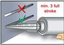
2. Der Mörtelvorlauf darf nicht zur Befestigung der Ankerstange verwendet werden. Daher Vorlauf solange verwerfen, bis sich eine gleichmäßig graue Mischfarbe eingestellt hat, jedoch min. 3 volle Hübe. Bei Schlauchfoliengebände sind min. 6 Hübe zu verwerfen.
