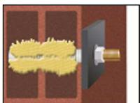
9. Nach vollständiger Aushärtung kann das Anbauteil mit bis zu dem maximalen Installationsdrehmoment (siehe Anhang C4-C34) montiert werden. Die Mutter muss mit einem kalibrierten Drehmomentschlüssel angezogen werden.
