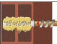
7. Vor dem Einsetzen der Ankerstange ist die Verankerungstiefe auf der Ankerstange zu markieren. Befestigungselement mit leichten Drehbewegungen bis zur festgelegten Setztiefe eindrücken. Die Ankerstange muss schmutz-, fett-, und ölfrei sein.
