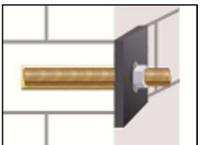
9. Nach vollständiger Aushärtung kann das Anbauteil mit bis zu dem maximalen Installationsdrehmoment (siehe Anhang C4-C34) montiert werden. Die Mutter muss mit einem kalibrierten Drehmomentschlüssel angezogen werden.
