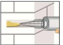
5. Das Bohrloch vom Grund her zu mindestens 2/3 mit Mörtel füllen. Langsames Zurückziehen des Statikmischers aus dem Bohrloch verhindert die Bildung von Lufteinschlüssen.
