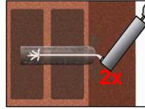
4. Bohrloch vom Bohrlochgrund her zweimal ausblasen. Die Stahlbürste mit passender Größe ( $> d_{b,min}$  Tabelle B2 oder B3) in eine Bohrmaschine oder einen Akkuschauber einstecken, das Bohrloch zweimal ausbürsten und abschließend erneut zweimal ausblasen.
