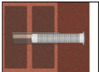
5. Die Siebhülse bündig mit der Oberfläche des Verankerungsgrundes in das Bohrloch einstecken. Sicherstellen, dass die Siebhülse optimal ins Bohrloch passt. Siebhülse niemals kürzen, außer SH 16x130/330. Für Installation der SH 16x130/330 Siebhülsenlänge bestimmen und von der Spitze her auf die gewünschte Länge abschneiden und Kappe aufsetzen. Nur Siebhülsen mit richtiger Länge verwenden.
