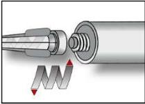
1. Den mitgelieferten Statikmischer fest auf die Kartusche aufschrauben und Kartusche in eine geeignete Auspresspistole einlegen. Bei Schlauchfolienkartuschen den Clip vor der Verwendung abschneiden.
