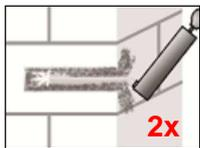
4. Bohrloch vom Bohrlochgrund her zweimal ausblasen. Die Stahlbürste mit passender Größe ( $> d_{b,min}$  Tabelle B2 oder B3) in eine Bohrmaschine oder einen Akkuschrauber einstecken, das Bohrloch zweimal ausbürsten und abschließend erneut zweimal ausblasen.
