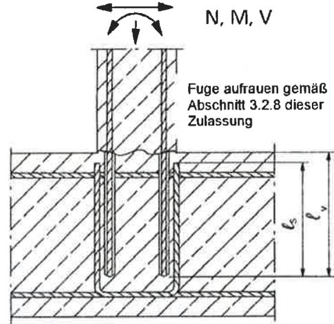
**Bild 3:** Endverankerung von Platten oder Balken
