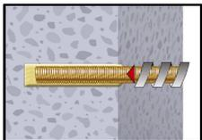
8. Befestigungselement mit leichten Drehbewegungen bis zur festgelegten Setztiefe einführen. Die Ankerstange muss schmutz-, fett-, und ölfrei sein.
