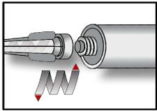
3. Den mitgelieferten Statkmischer fest auf die Kartusche aufschrauben und Kartusche in eine geeignete Auspresspistole einlegen. Bei jeder Arbeitsunterbrechung länger als die maximale Verarbeitungszeit (Tabelle B5) und bei jeder neuen Kartusche ist der Statkmischer zu erneuern.
