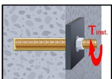
11. Nach vollständiger Aushärtung kann das Anbauteil mit bis zu dem maximalen Drehmoment (Tabelle B1 oder B3) montiert werden. Die Mutter muss mit einem kalibriertem Drehmomentschlüssel festgezogen werden. Bei der Vorsteckmontage kann optional der Ringspalt zwischen Ankerstange und Anbauteil nachträglich mit Mörtel verfüllt werden. Dafür Unterlegscheibe durch Verfüllscheibe ersetzen und Mischerrückführung auf den Mischer stecken. Der Ringspalt ist verfüllt, wenn Mörtel austritt.
