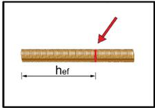
4. Vor dem Injizieren des Mörtels die geforderte Setztiefe auf der Ankerstange markieren.
