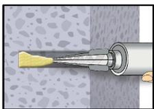
6. Gereinigtes Bohrloch vom Bohrlochgrund her ca. zu 2/3 mit Verbundmörtel befüllen. Langsames Zurückziehen des Statkmischer aus dem Bohrloch verhindert die Bildung von Luftporen. Wird der Bohrlochgrund nicht erreicht, muss eine passende Mischerverlängerung verwendet werden. Die temperaturrelevanten Verarbeitungszeiten (Tabelle B5) sind zu beachten.
