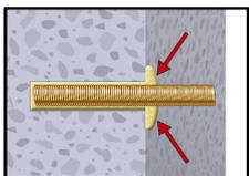
9. Nach der Installation des Ankers muss der Ringspalt zwischen Ankerstange und Beton, bei Durchsteckmontage zusätzlich auch Anbauteil, komplett mit Mörtel ausgefüllt sein. Tritt keine Masse nach Erreichen der Verankerungstiefe heraus, ist diese Voraussetzung nicht erfüllt und die Anwendung muss vor Beendigung der Verarbeitungszeit wiederholt werden. Bei Überkopfmontage ist die Ankerstange zu fixieren (z.B. Holzkeile).
