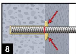
8. Nach Installation des Bewehrungsstabs sicherstellen, dass sich die Setztiefenmarkierung an der Bohrlochoberfläche befindet und der Ringspalt komplett mit Mörtel ausgefüllt ist. Tritt keine Masse nach Erreichen der Setztiefe heraus, ist diese Voraussetzung nicht erfüllt und die Anwendung muss vor Beendigung der Verarbeitungszeit wiederholt werden. Bei Überkopfmontage ist der Bewehrungsstab zu fixieren (z.B. Holzkeile).
