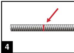
4. Vor dem Injizieren des Mörtels ist die Setztiefe auf dem Bewehrungsstab zu markieren (z.B. mit Klebeband). Danach den Bewehrungsstab in das leere Bohrloch einführen, um die korrekte Bohrlochtiefe  $l_v$  zu überprüfen.
