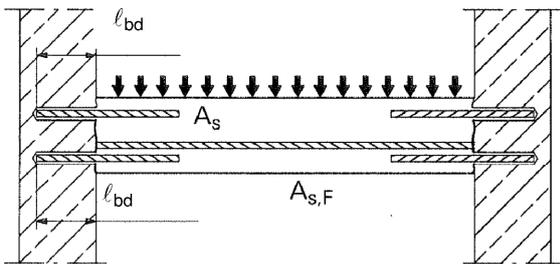
**Bild A5:** Verankerung von Bewehrung zur Deckung der Zugkraftlinien
