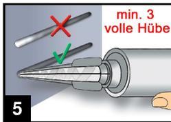
5. Mörtelvorlauf ist nicht zur Befestigung des Bewehrungsseisens geeignet.
