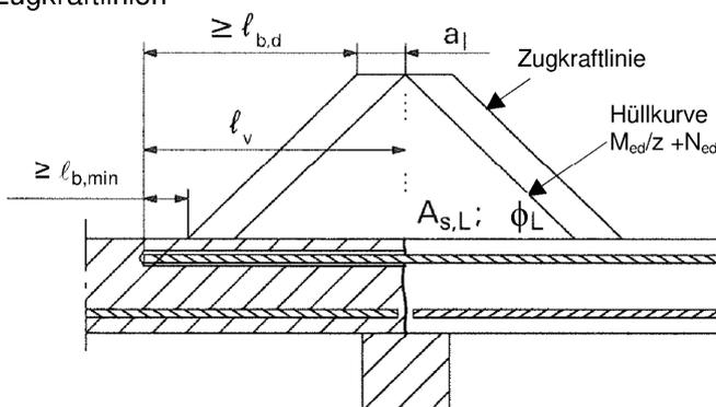
**Bild A2:** Übergreifungsstoß einer biegebeanspruchten Stütze oder Wand an ein Fundament
