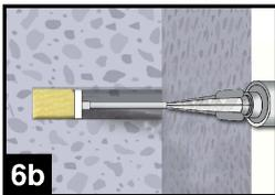
Für die Horizontal- oder Überkopfmontage, sowie bei Bohrlochertiefen tiefer als 240mm sind Verfüllstützen zu verwenden.
