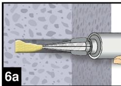
6. Gereinigtes Bohrloch vom Bohrlochgrund her ca. zu 2/3 mit Verbundmörtel befüllen.
