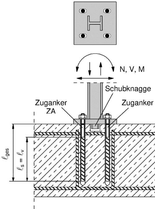
**Bild A7:** Übergreifungsstoß für die Verankerung von Geländerpfosten
