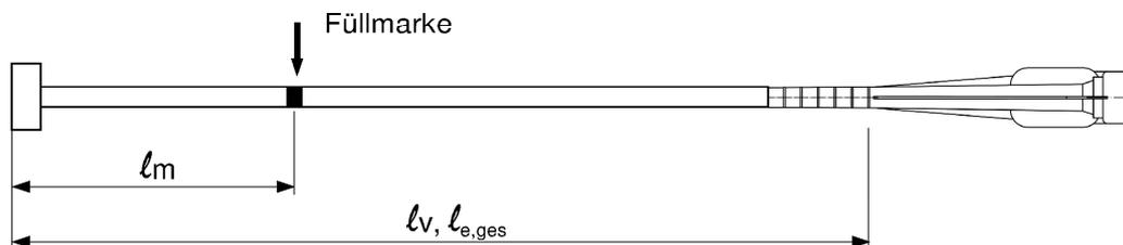
Das Injektionszubehör muss Mörtel-Füllmarke  $l_m$  und Verankerungstiefe  $l_v$  bzw.  $l_{e,ges}$  mit einem Klebeband oder Textmarker markiert werden. Grobe Abschätzung:  $l_m = 1/3 \cdot l_v$  Bohrloch mit Mörtel befüllen, bis die Mörtel-Füllmarke Markierung  $l_m$  sichtbar wird.
