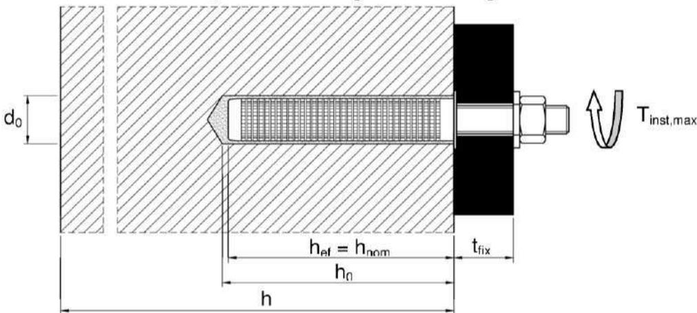
**Installation in Vollstein; Gewindestange oder Innengewindehülse ohne Siebhülse**
