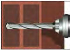
3. Das Bohrloch, senkrecht zur Oberfläche des Verankerungsgrundes, mit Bohrverfahren nach Anhang C4-C45, mit vorgeschriebenem Bohrerinnendurchmesser und Bohrlochtiefe entsprechend der Ankergröße und Einbindetiefe des gewählten Dübels, im Verankerungsgrund erstellen.
