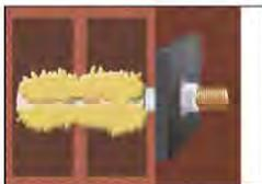
9. Nach vollständiger Aushärtung kann das Anbauteil mit bis zu dem maximalen Installationsdrehmoment (siehe Anhang B4) montiert werden. Die Mutter muss mit einem kalibrierten Drehmomentschlüssel angezogen werden.
