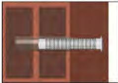
5. Die Siebhülse bündig mit der Oberfläche des Verankerungsgrundes in das Bohrloch einstecken. Sicherstellen, dass die Siebhülse optimal ins Bohrloch passt. Siebhülse niemals kürzen.
