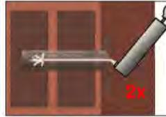
4. Bohrloch vom Bohrlochgrund her zweimal ausblasen. Die Stahlbürste mit passender Größe ( $> d_{b,min}$  Tabelle B3) an einer Bohrmaschine oder einen Akkuschauber einstecken, das Bohrloch zweimal bürsten und abschließend erneut zweimal ausblasen.
