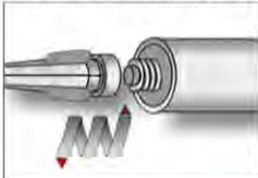
1 Die Kappe von der Kartusche entfernen und den mitgelieferten Statikmischer fest auf die Kartusche aufschrauben und Kartusche in eine geeignete Auspresspistole einlegen. Bei Schlauchfolien den Clip vor der Verwendung abschneiden. Bei jeder Arbeitsunterbrechung länger als die empfohlene Verarbeitungszeit (Tabelle B4 und B5) und bei jeder neuen Kartusche ist der Statikmischer zu erneuern.
