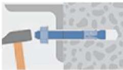
Dübel und Bauteil positionieren
