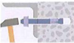
Dübel und Bauteil positionieren
