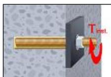
10. Nach vollständiger Aushärtung kann das Anbauteil mit dem zulässigen Drehmoment (Tabelle B1) montiert werden. Die Mutter muss mit einem kalibrierten Drehmomentschlüssel festgezogen werden.
