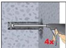
Bohrlöcher bis Durchmesser 20 mm dürfen mit der Handpumpe ausgeblasen werden.
