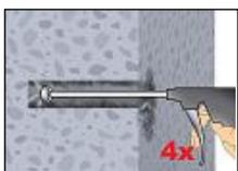
**Nach der Reinigung ist das Bohrloch bis zum Injizieren des Mörtels vor erneutem Verschmutzen in einer geeigneten Weise zu schützen. Ggf. ist die Reinigung unmittelbar vor dem Injizieren des Mörtels zu wiederholen.**
